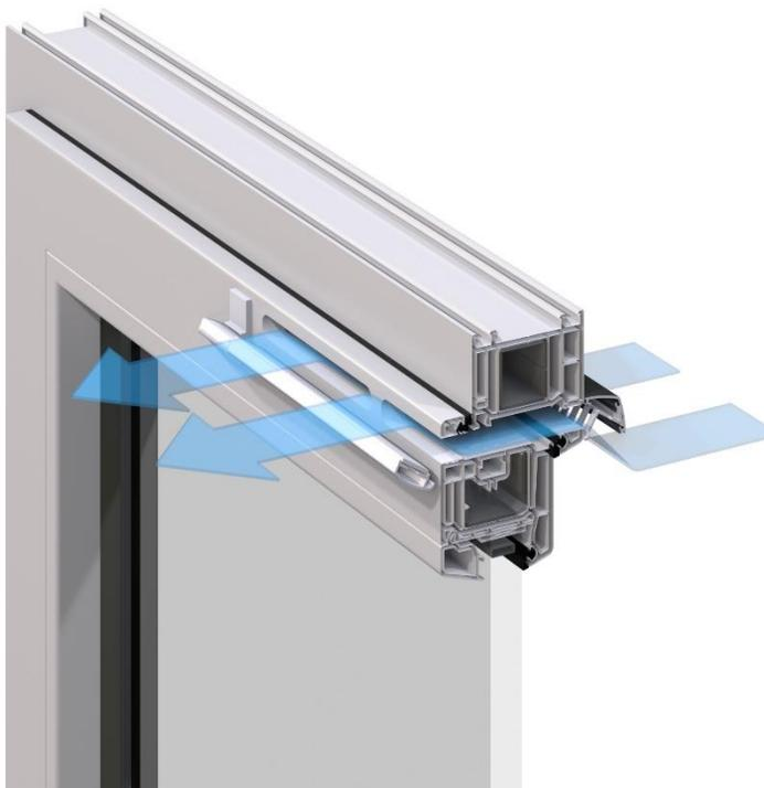
Приточный клапан АЛ-35 устанавливается на ПВХ окно с фрезеровкой створки и рамы. Воздух проходит через притвор окна
